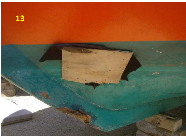
Εικόνες 13, 14: Τα σημεία ρηγματώσεων στην αριστερή πλευρά και η παραμόρφωση στο πρωραίο ποδόστημα.
