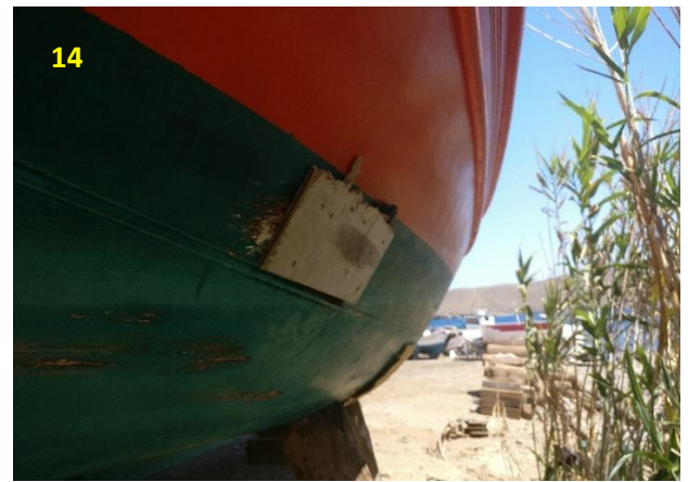
Εικόνες 13, 14: Τα σημεία ρηγματώσεων στην αριστερή πλευρά και η παραμόρφωση στο πρωραίο ποδόστημα.
