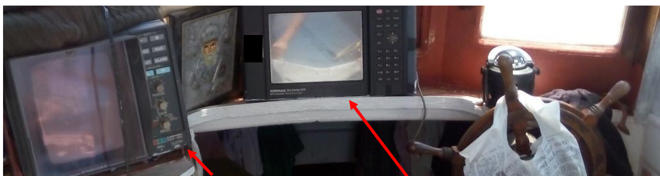
Εικόνα 6: Συσκευή βυθομέτρου FURUNO FCV 561 και συσκευή ηλεκτρονικών χαρτών SIMRAD Shipmate RS2400
