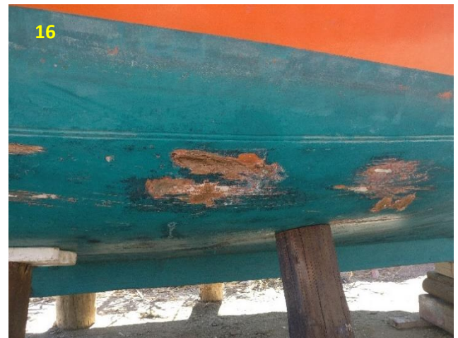
Εικόνες 13, 14: Τα σημεία ρηγματώσεων στην αριστερή πλευρά και η παραμόρφωση στο πρωραίο ποδόστημα.
