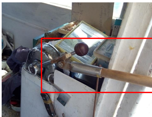
Εικόνα 4: Χειριστήριο ελέγχου της προωστήριας μηχανής. Η διάταξη προέκτασης συνδεδεμένη στον μοχλό χειριστηρίου.
